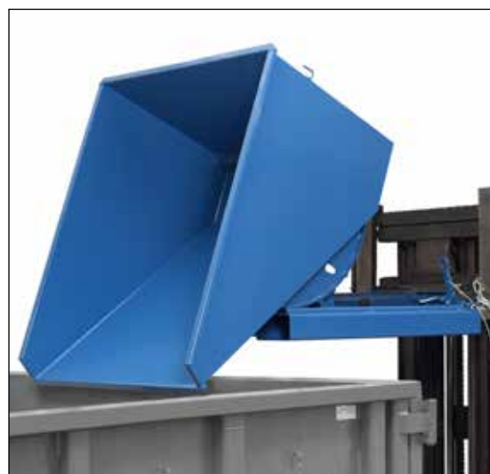
Benne auto-basculante comme collecteur de déchets. Déplacement par chariot élévateur
